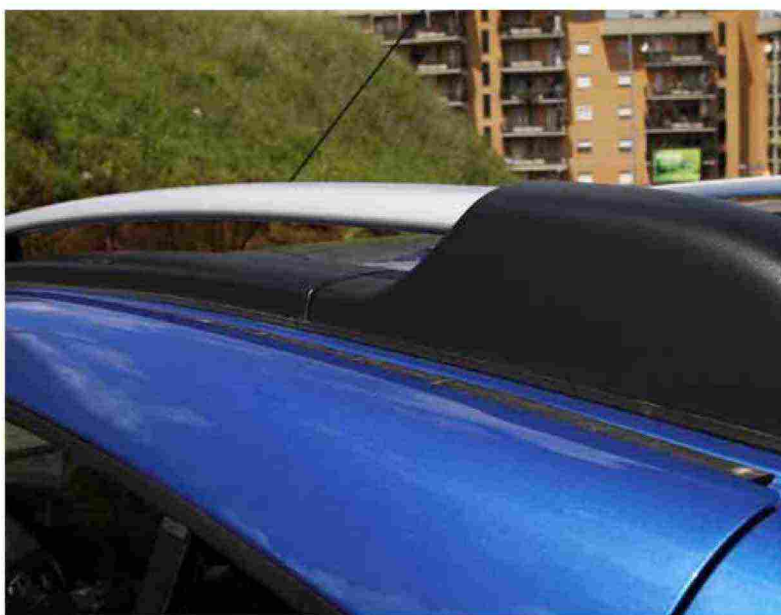
Barre longitudinali sul tetto (Foto Archivio)
